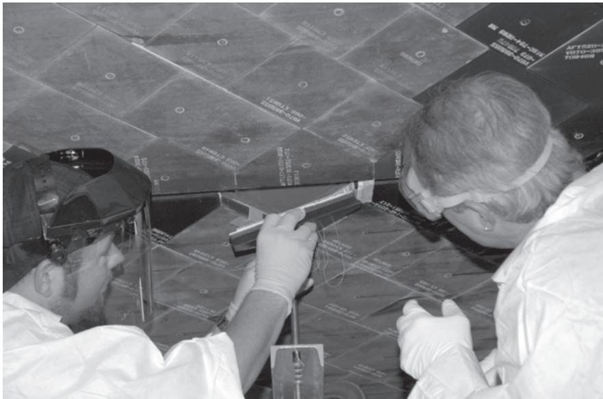
**Figura C.7.1.** Blocos cerâmicos de proteção térmica aplicados na parte inferior de um vaivém espacial.
