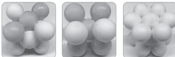
**Figura A.3.1.** – Modelos das estruturas cristalinas CFC, CCC e HC.
