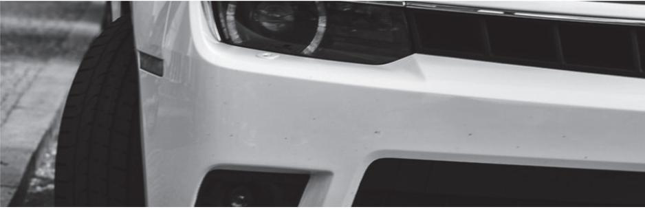
**Figura 13.14.** Exemplo de um componente automóvel (para-choques) produzido por impregnação de resina.
