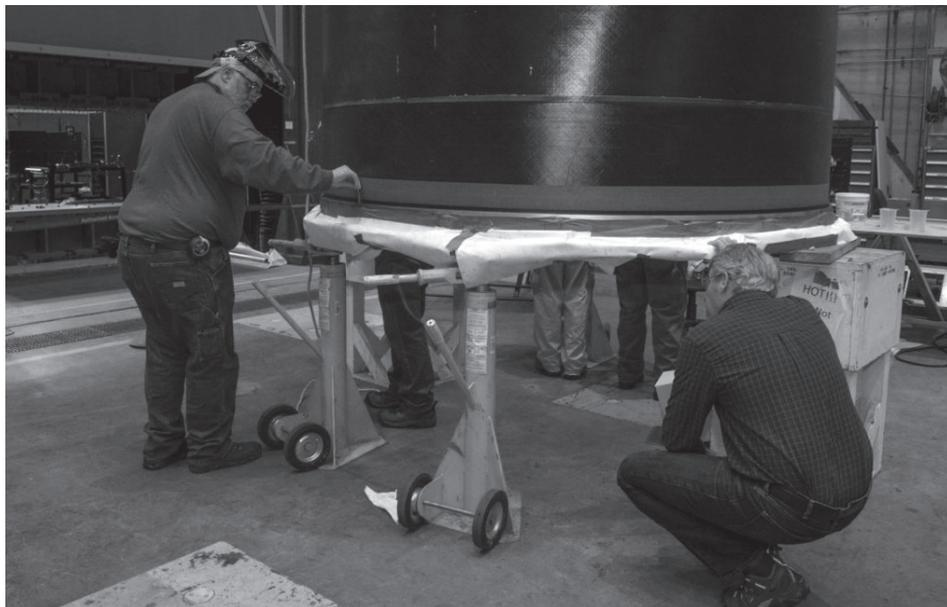
**Figura 12.31.** Aplicação de resina epóxida na construção de veículos aeroespaciais.
