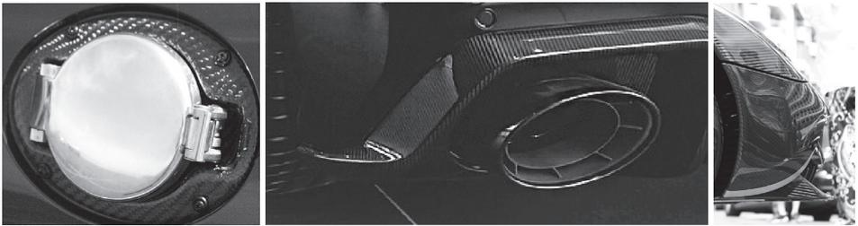
**Figura 13.7.** Materiais compósitos reforçados com fibras de carbono utilizados em aplicações automotivas.
