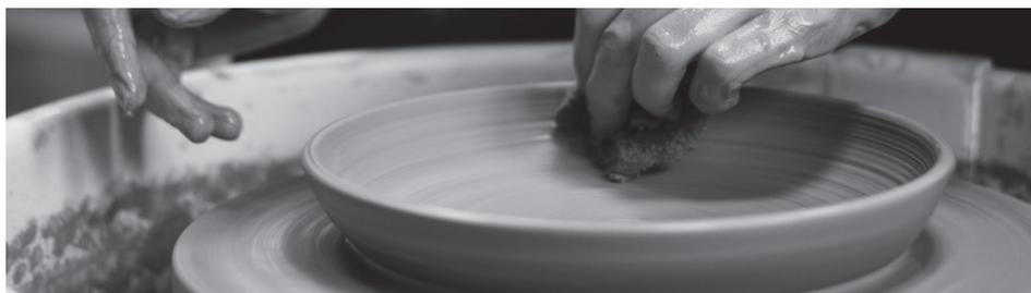
**Figura 11.9.** Processo de conformação manual de materiais cerâmicos.
