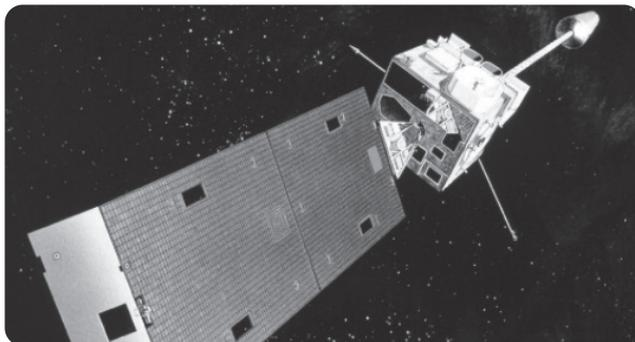
**Figura 10.17.** Exemplo de painel solar extensível com recurso a uma estrutura em liga de memória de forma.
