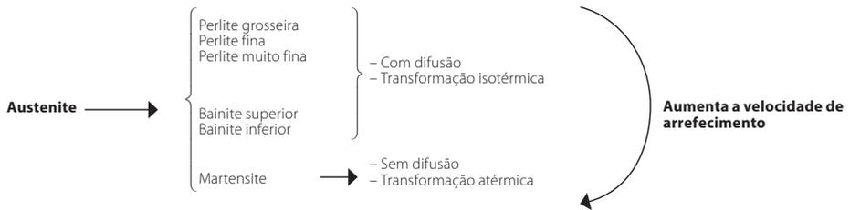
Figura 8.17. Estruturas micrográficas em função da velocidade de arrefecimento.
