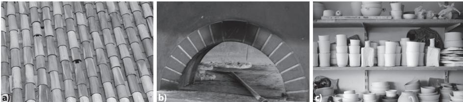
**Figura 11.1.** Exemplos de aplicações típicas de cerâmicos tradicionais. Telhas para construção civil **a)**, materiais refratários para a construção de fornos **b)** e louças e artigos decorativos **c)**.
