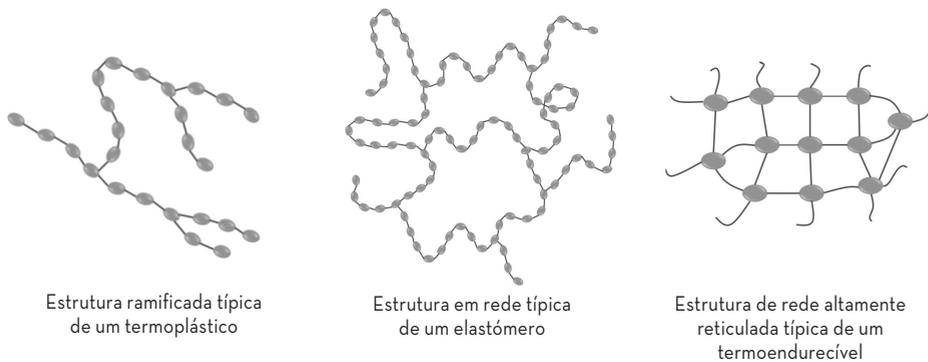
**Figura 4.2.** Estruturas moleculares típicas de polímeros termoplásticos, elastômeros e termoendurecíveis.
