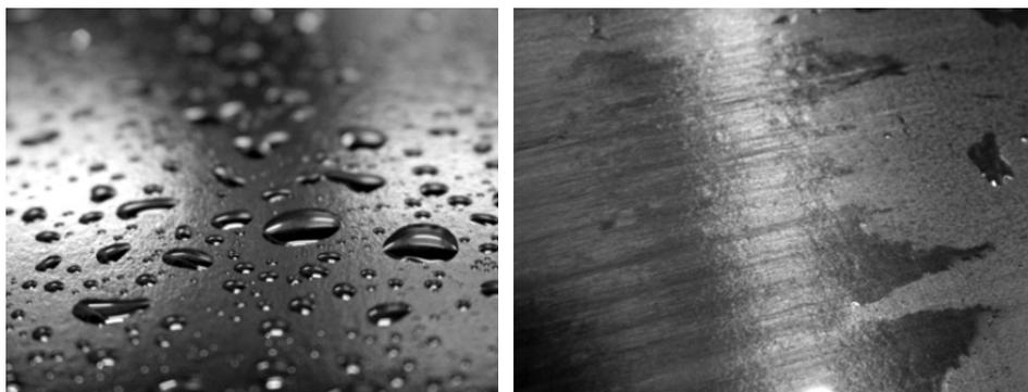
**Figura 6.2.** Teste de quebra de água. À esquerda: superfície com baixa energia superficial. À direita: superfície com alta energia superficial
