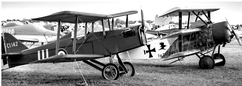
**Figura 1.2.** Aeronaves usadas na Primeira Grande Guerra Mundial de construção em madeira colada.
