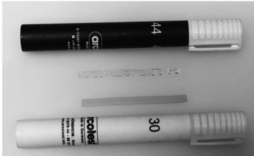
**Figura 6.3.** Marcadores para controlo da energia superficial e exemplo de linhas por eles geradas numa superfície polimérica. No exemplo mostrado a energia superficial está contida entre 44 e 30 mJ m<sup>-2</sup>
