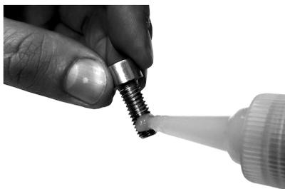
**Figura 5.4.** Processo de aplicação de um adesivo na forma líquida.
