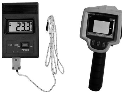
**Figura 6.5.** Sistema de termopar para medição por contacto da temperatura (esquerda) e câmara de infravermelhos para medição da temperatura sem contacto (direita).
