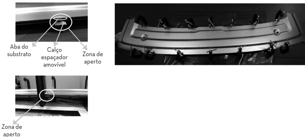
**Figura 5.9.** Sistema de fixação de uma estrutura colada usada na indústria automóvel.
