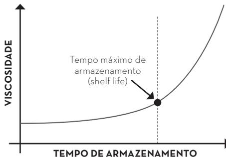
Figura 5.2. Relação entre viscosidade e tempo de armazenamento de um adesivo.
