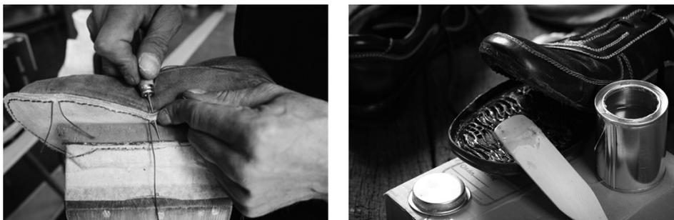
**Figura 1.11.** Processo tradicional de fabrico por costura (esquerda) e a aplicação de adesivo no fabrico de calçado (direita).
